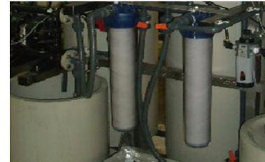
A solução é impulsada mediante uma bomba pneumática através da resina de troca iônica de características especiais que retêm o ácido sulfúrico, deixando passar o alumínio como sulfato de alumínio. Desta forma se consegue um efluente que pode ser tratado facilmente devido a sua concentração moderada de ácido sulfúrico e alumínio.
